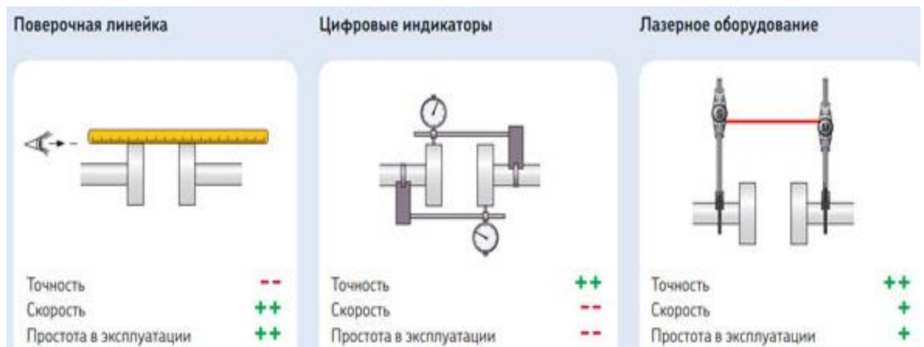
Рисунок 2 – Способы измерений соосности валов
