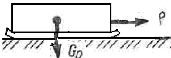
Рисунок 10- Расчетная схема перемещения груза на санях по горизонтальной плоскости
