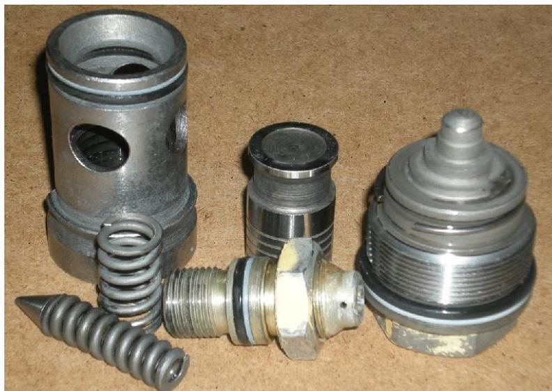
Рисунок 51 – Детали предохранительного клапана
