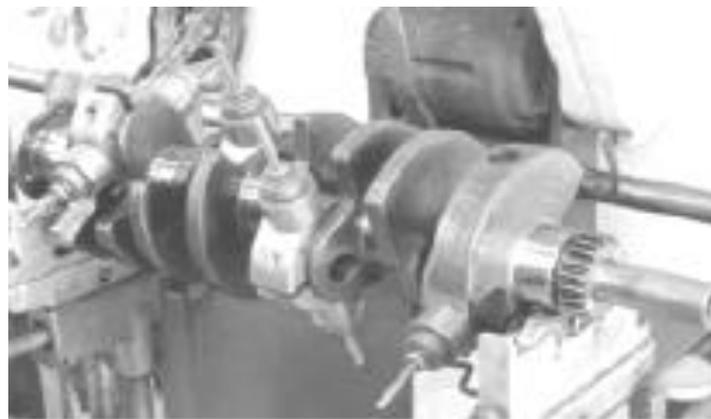
Рисунок 8 - Внешний вид противовесов (бобвейтов), установленных на шатунные шейки
