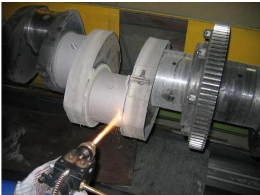
Рисунок 27 – Газопламенное напыление
