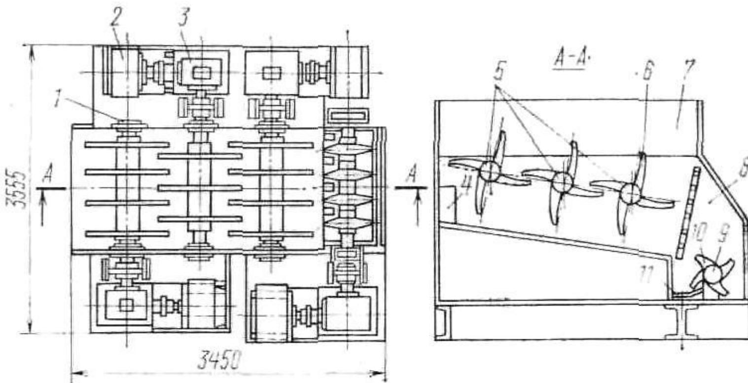
Рис. 1.3. Валковая стружкодробилка конструкции УЗТМ
